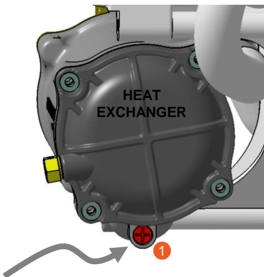
ENGINE COOLANT DRAIN PLUG
